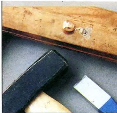
Заклепки и шурупы из мягких сплавов, например, латуни или меди легко срубить зубилом.
