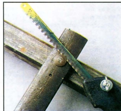
В труднодоступных местах головки заклепок или шурупов можно спилить.
